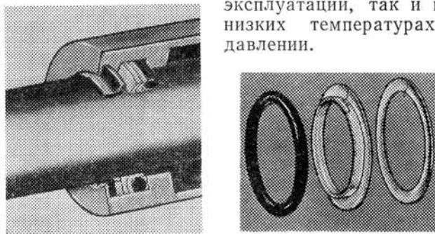
Рис. 4. Уплотнение для плунжеров гидроцилиндров
